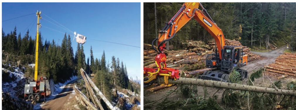
Фиг. 1. С въжана линия VALENTINI 400 се извозват цели дървета до камионен път (а), където кастренето и разкрояването на сортименти се извършва с кран – процесор WOODY H60, монтиран на колесен багер DOOSAN (б)
