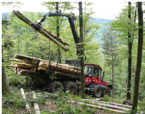
Фиг. 8. Безопасен извоз на стръмен терен с форвардер VALMET снабден с тракционната лебедка
