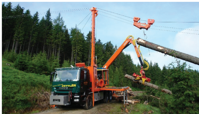
Фиг. 3. Комбинирана мобилна въжена линия (планински харвестър) SYNCRO-FALKE 3t, монтирана върху базовото шаси на товарен автомобил IVECO и процесор WOODY H60 монтиран на стрелата на кран
