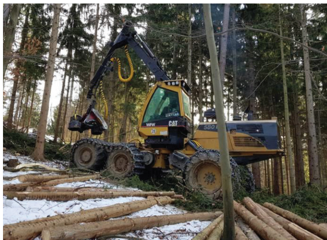
Фиг. 5. Колесен харвестър CAT 580 В с окачване тип бъги за работа на наклонени терени
