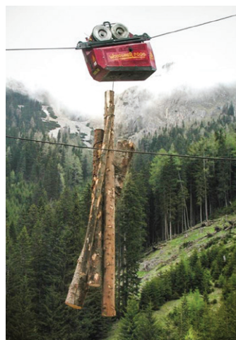
Фиг. 6. Извоз със самоходен вагон „Woodliner“, задвижван от вграден в него двигател
