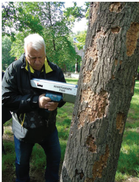
Фиг. 2. Измерване степента на гнилото с Resistograph „F300“
