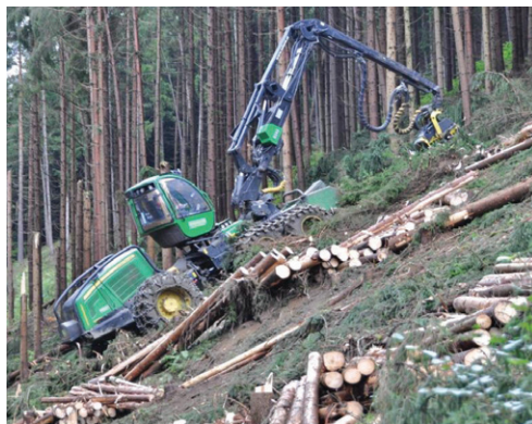
Фиг. 7. Напълно механизирен дърводобив на стръмен склон. Харвестър JOHN DEER с допълнително монтирана тракционна лебедка
