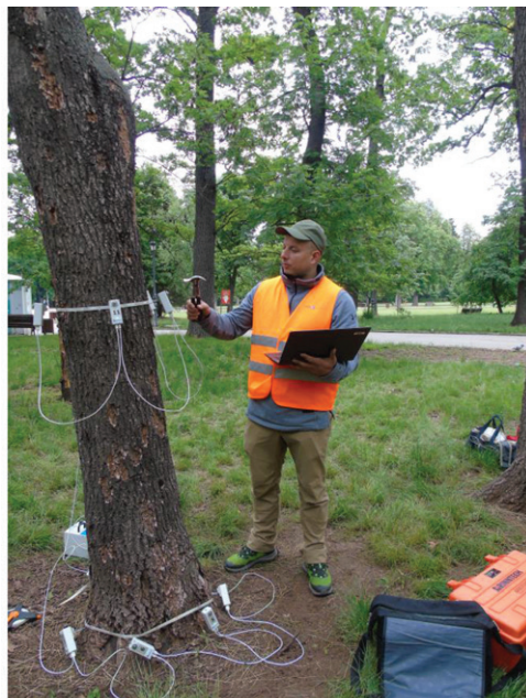
Фиг. 3. Обследване на дърво с помощта на томограф „Arbotom“
